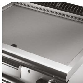
Die Neigung der Platte um 10 mm zur Vorderseite des Gerätes ermöglicht ein optimales Abfließen des Fettes in die Sammellade.
